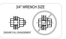
DO NOT OVERTIGHTEN BOLTS. ONLY TIGHTEN THE JOINT BY 1/3 OF A TURN PAST THE SNUG TIGHT CONDITION
